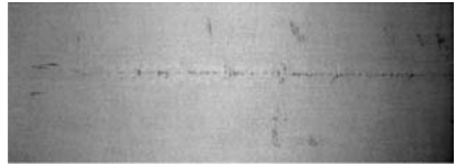
图 1 带缺陷的铸坯原图
