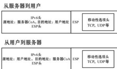
(b) 去除目的地选项头和第二类路由报头之后数据包格式
