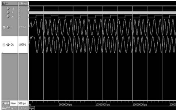
图 4 MSK 基带调制 Modelsim 仿真波形图
