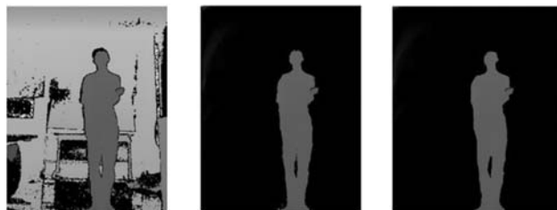
(a) 原始深度图像 (b) 掩码深度图像 (c) 平滑后的深度图像
