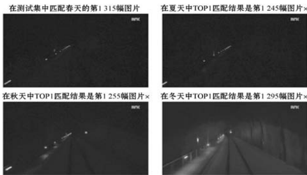
图 9 隧道内弱光照时 RIV-LCD 匹配到的错误图像
