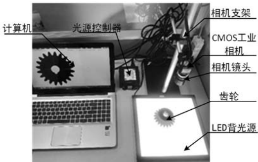
图 1 齿轮视觉测量平台
