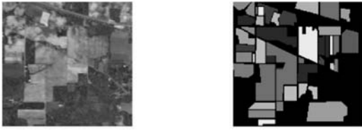
(a) 实际地面图 (b) 波段 50、27 和 17 组成的伪彩色图
