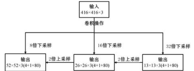
图 1 YOLO V3 网络结构示意图
